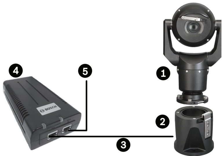
Afbeelding 12.1: Standaard IP-configuratie met midspan 95 W (geen I/O-aansluitingen)
