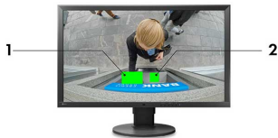
Een voorbeeld van maskeringen voor gegevensbeveiliging bij een geldautomaat: 1. gecamoufleerde pinpas, 2. gecamoufleerd toetsenbord
